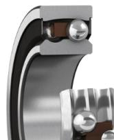
**بلبرینگ:** یاتاقان های توبی خودآرایی دارای دو ردیف توب، یک مسیر مسابقه کروی متداول در حلقه بیرونی و دو شیار عمیق مسابقه بدون وقفه در حلقه داخلی هستند. آنها به سوت باری مهر و موم شده موجود هستند. یاتاقان ها نسبت به عدم انتقالی رازوه ای شافت نسبت به محفظه حسامن نیستند (شکل ۱)، که می تواند به عنوان مثال، با انحراف شافت ایجاد شود.
